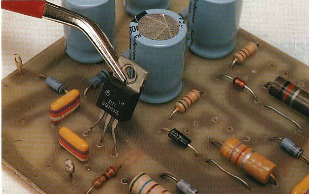
L'integrato IC1 (nella foto) e i due transistor T1 e T2 sono alloggiati in contenitori TO 220. Occorre prestare una certa attenzione per non confonderli.
